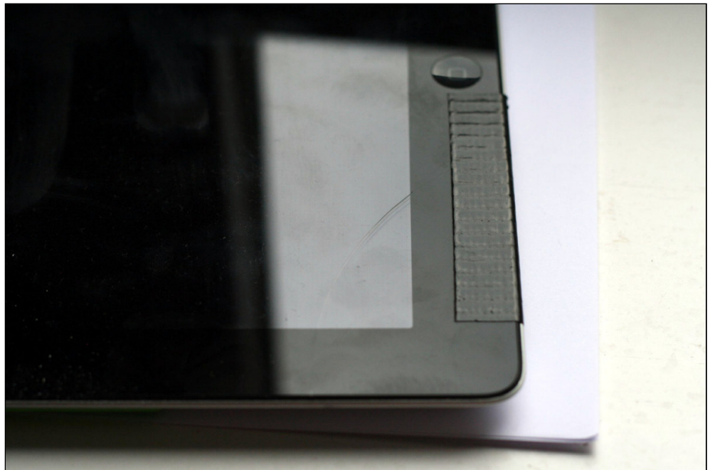
Abb. 1: Fixierter Display-Riss im iPad, Hamburg 2014, Foto: SR.
